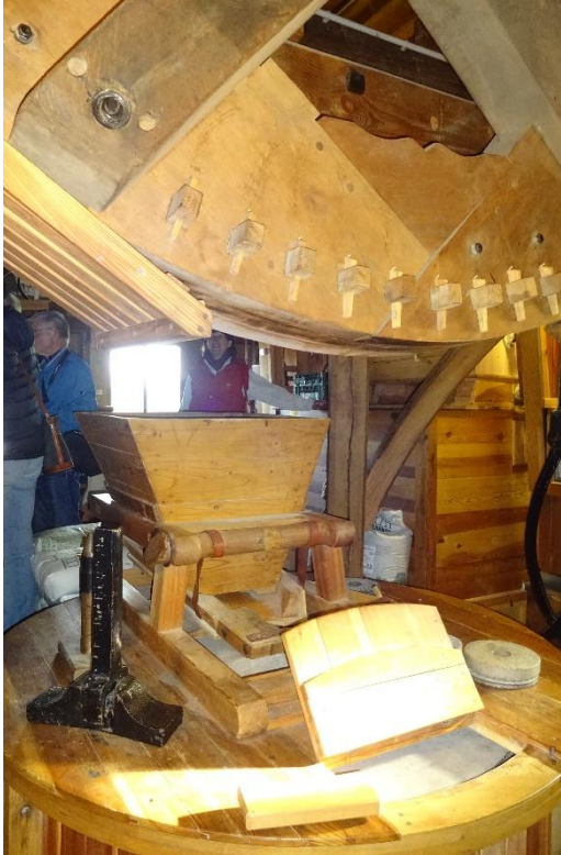
Abb. 20: Kammer mit Bremse (Steinboden), Mahlgang mit Blick auf den oberen Mühlstein
