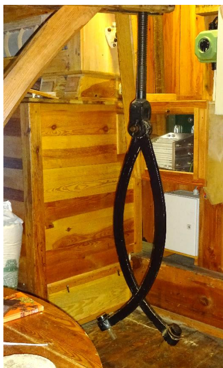
Abb. 19: Steinkranz zum Herausheben und Schleifen der Steine
