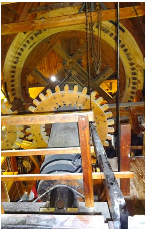
Abb. 18: Dachbereich: Rutenwelle mit Kammrad und Presse (Bremse)
