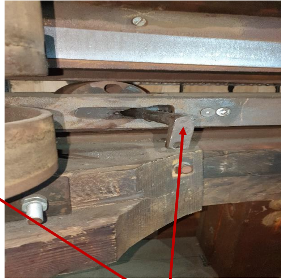
Entfernung der Rollenachse mit Sicherungsflasche.
